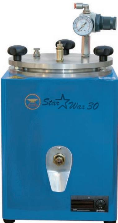
Gli iniettori STARWAX sono costruiti con il serbatoio in alluminio per una veloce ed uniforme diffusione del calore. Hanno due resistenze e un nuovo termostato più sensibile ed affidabile. Sono disponibili con capacità da 1,5 o 3 Kg, completi di manometro, pompa manuale o riduttore per l'aria compressa (in questo caso è prevista una valvola di sicurezza) e tre diversi ugelli intercambiabili.
