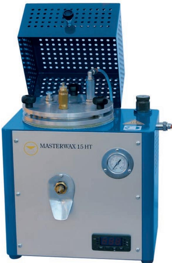
Particolare versione dell'iniettore da kg 1,5 indicato per cera per scultura, in grado di fondere fino a 145°. Dotato di termostato digitale, è disponibile solamente con attacco per aria compressa, in quanto la cera per scultura necessita di una pressione di 2,5-3 bar per essere iniettata. E' fornito con tre diversi ugelli.
