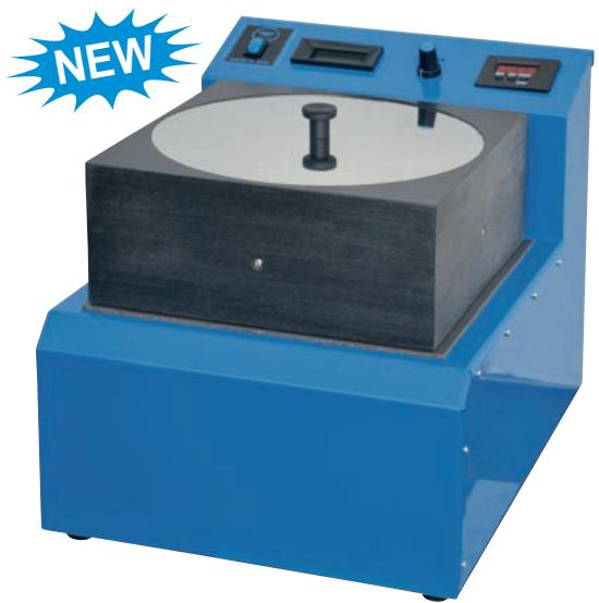
I buratti magnetici permettono la lucidatura di oggetti metallici di difficile finitura, anche in presenza di pietre, mediante lo sfregamento di aghi in acciaio magnetico inossidabile.
