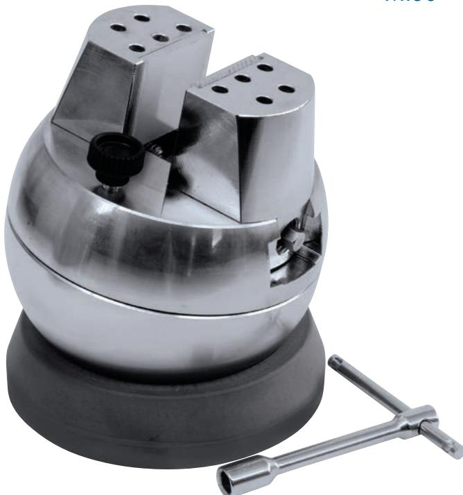
Morsa sferica orientabile e girevole per incisori; la parte girevole superiore appoggia su un cuscinetto a sfere sul quale ruota con facilità di 360° ed è facilmente bloccabile in posizione di lavoro con l'apposito pomolo. Il peso adeguato ne garantisce la perfetta stabilità sul cuscino in gomma.
