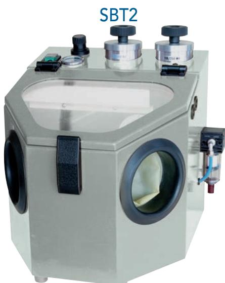
Mini-sabbiatrici da banco da uno a tre moduli che possono utilizzare sabbie all'ossido d'alluminio e microsfere di vetro con granulometria compresa tra 50 e 250 micron. Sono equipaggiate di filtro aria in entrata, ugelli in widia, selettore sabbia interno, regolatore di pressione e manometro. Hanno il comando a pedale e cabina di sabbiatura illuminata e dotata di guanti. Predisposte per essere collegate ad un eventuale aspiratore esterno.
