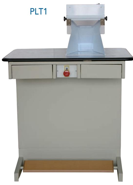
Banco per aspirazione nei lavori di lucidatura di oggetti metallici, predisposto per l'installazione di un motore pulitrice singolo. E' dotato di un motore aspirante da 180 m3/H, cuffia aspirazione con illuminazione al neon e due cassetti porta-oggetti.
