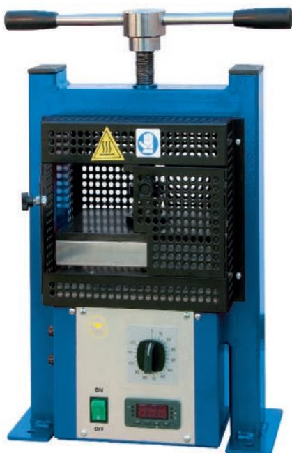
Vulcanizzatore per gomme siliconiche od organiche, munito di pistone premi-gomma (escursione massima 15 mm) con termostato digitale. Piastre scaldanti in alluminio per un'ottima diffusione del calore, adatte alla maggior parte delle staffe disponibili sul mercato.
